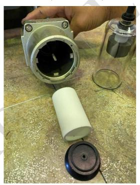
5. Si nécessaire, les filtres peuvent être changés, nettoyés et remontés.
