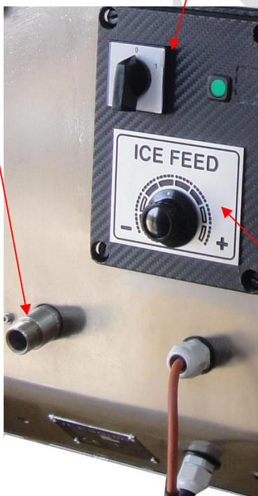
Interrupteur électrique ON/OFF
