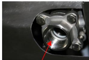
Arrivée d'air comprimé
