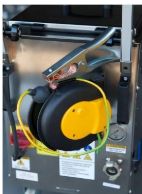
Dériveur de tresse de masse: longueur : 7 mètres section : 6mm 2
