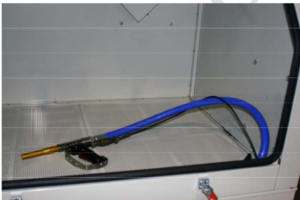
À l'intérieur de la chambre de la cabine, fixez le pistolet de tir au tuyau de tir.
